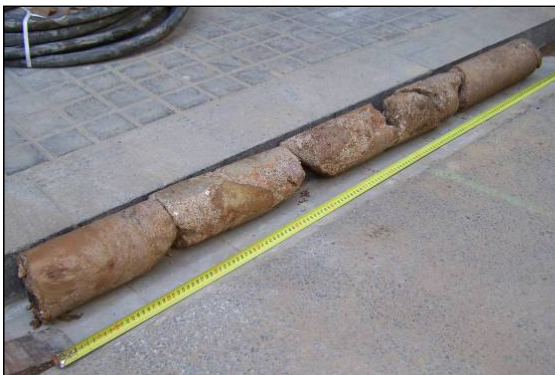
□oto□ra□a □□□Testimoni de la trepanació que confirma els 1'6 metres de grossor de la paret del Rec UE 205.
